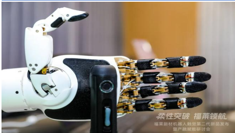
图17：搭载福莱新材柔性传感器的灵巧手
