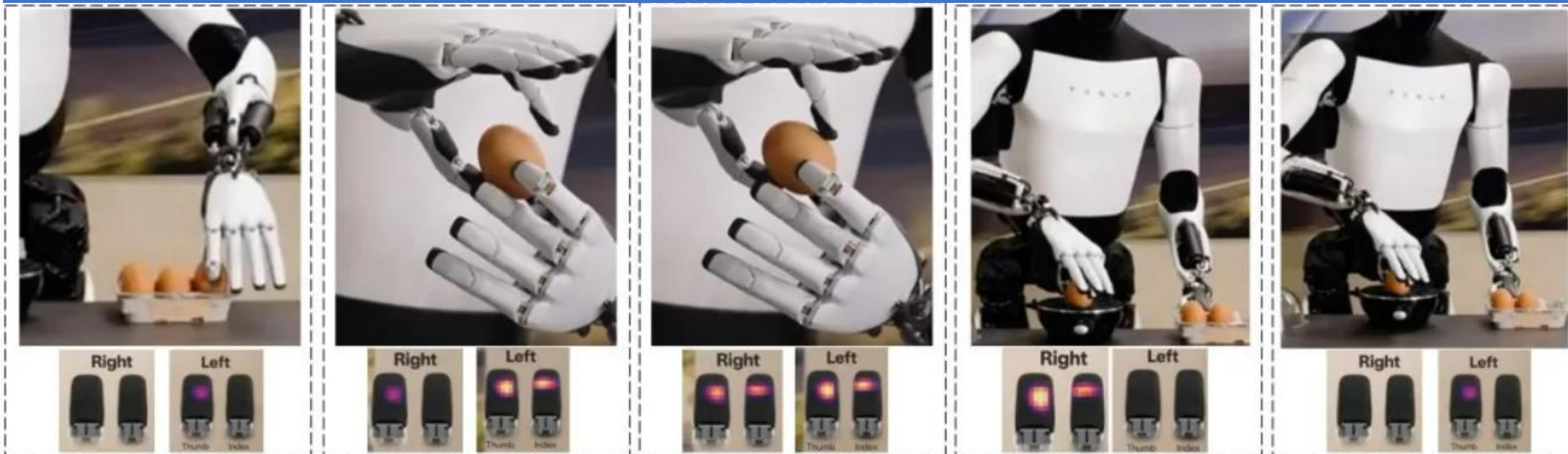
图16：二代灵巧手拿起、传递、释放鸡蛋的精准力控过程
